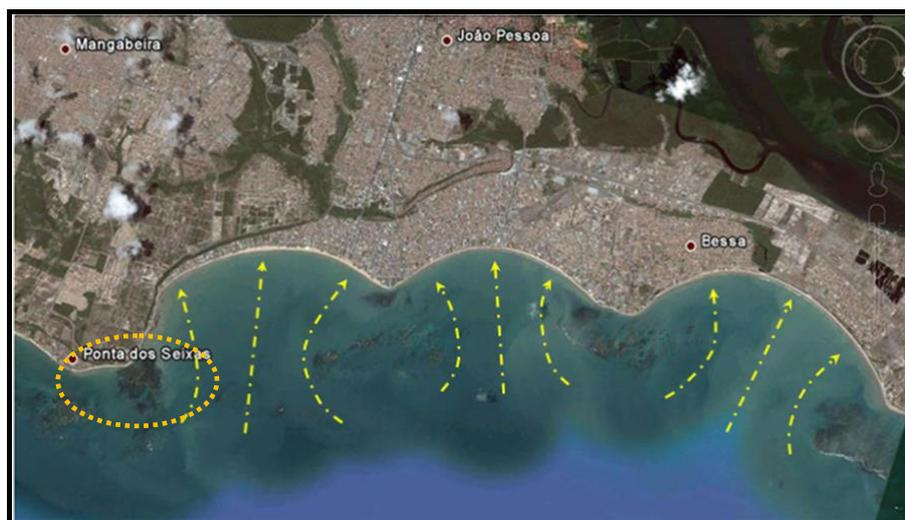
**Figura 4.** Caracterização morfológica do litoral de João Pessoa formada por enseadas desenvolvidas através do processo de difração das ondas. Detalhe para o círculo tracejado, destacando a abertura entre os recifes naturais existentes na área do empreendimento.
