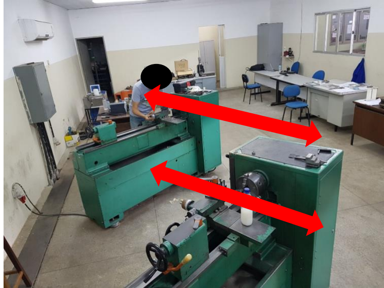
Figura 3 Direção dos cavacos dos tornos.
