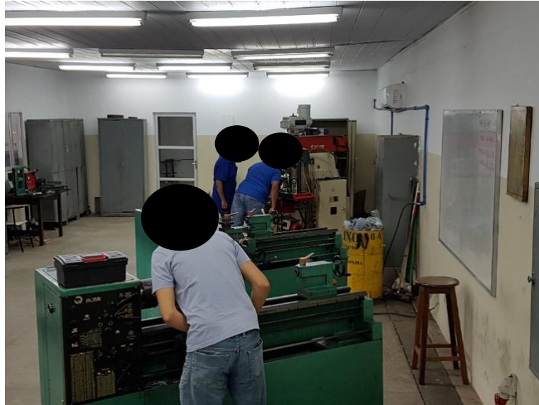
Figura 2 Máquinas operatrizes dispostas em ângulo.
