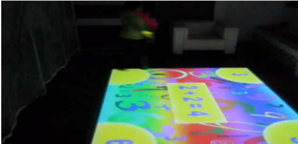
Figura 4 - Piso interativo usando sistema de visão ótica por projeção
