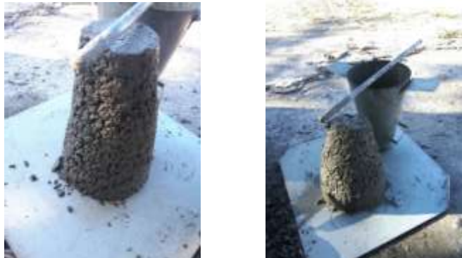
Figura 18 – Medida do abatimento de tronco de cone no concreto com adição de fibras
